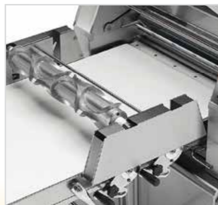
La stazione di taglio a due principi evita che la pasta si attacchi allo stampo. The double seat cutting station avoids the dough to stick in the moulds.
